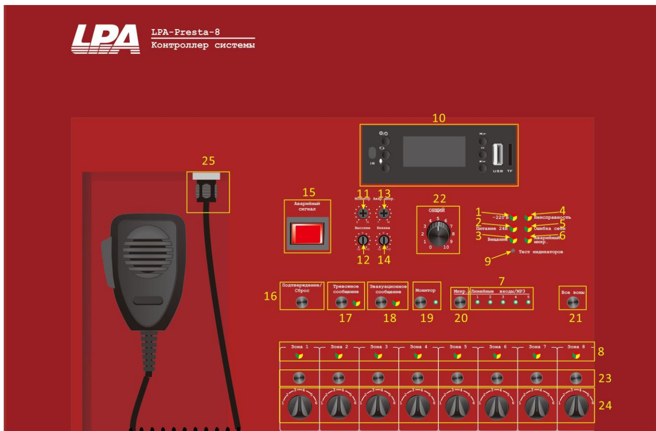
Рис. 2.1. Контроллер системы LPA-PRESTA-8 (передняя панель)
